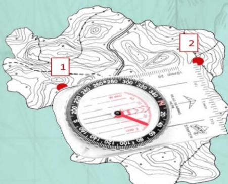
PASO 2: Girar el limbo hasta hacer coincidir la flecha N. con el N. del plano.
